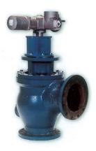
La válvula CHECKTRONIC es una válvula de "Seguridad por fallo de corriente" operada eléctricamente para el control de arranque y parada de bombas, provista de un sistema ajustable para controlar la velocidad de apertura y cierre, y así minimizar las sobrepresiones y golpes de ariete asociados a las operaciones normales de las bombas.
